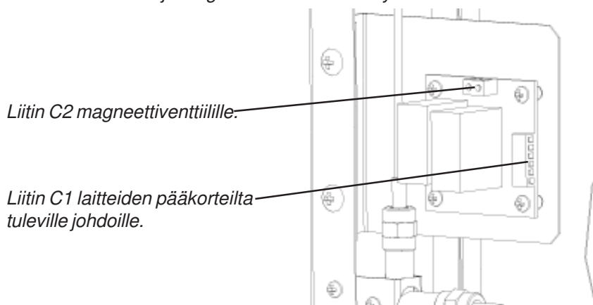
Kuva 4: Relekortin ja magneettiventtiilin kiinnitys liesiuuniin.
